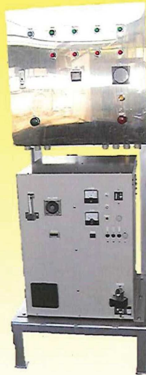
制御盤及びオゾン発生装置
